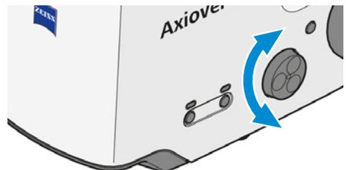
8. Falls erforderlich, den Neutralsichtfilter in den Strahlengang einschieben.
