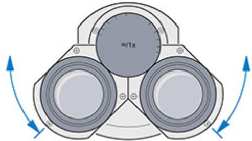
2. Die Einblickhöhe durch Schwenken des Okulars um bis zu 180° nach oben oder unten einstellen.
